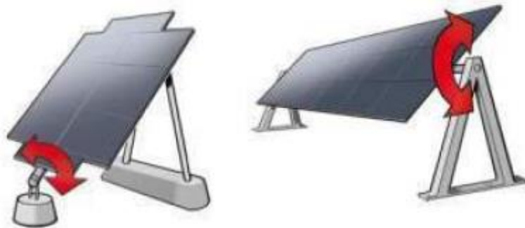
Kuva 48: Esimerkkejä yksiakselisista aurinkoseuraajista. Lähde: ABB
