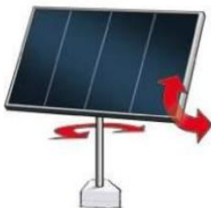
Kuva 49: Esimerkki kaksiakselisestä aurinkoseuraajasta. Lähde: ABB
