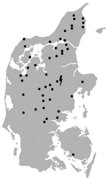
Kuva 73. Yksittäisen vian aiheuttamat yli 2 MW:n CHP-laitosten laukaisut (Nielsen 2003).
